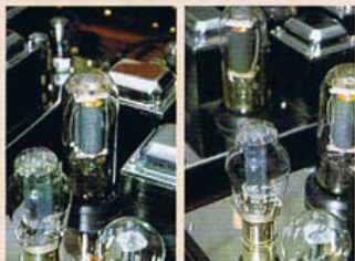
▲去年推出的No. 838MKII採用了Full Music 805的碩大真空管，配合300B的真空管作推動，令整款後級的輸出功率達到38W，能夠輕鬆推動任何低敏感度的揚聲器。此機中所採用的300B真空管雖為中國製造，但質素之佳遠勝部分外國古董產品。
